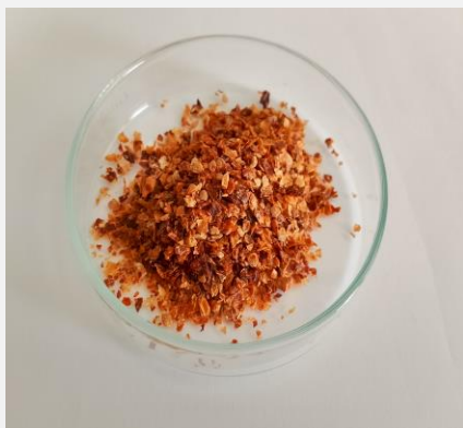
Rysunek 2 Proszek z pestek i skórek pomidorów po rozdrobnieniu do wielkości cząstek 0,5 mm.
