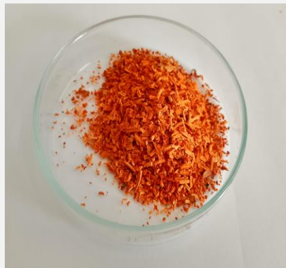
Rysunek 4 Proszek z pestek awokado po rozdrobnieniu do wielkości cząstek 0,5 mm.
