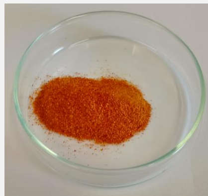
Rysunek 3 Proszek z pestek awokado po rozdrobnieniu do wielkości cząstek 0,3 mm.
