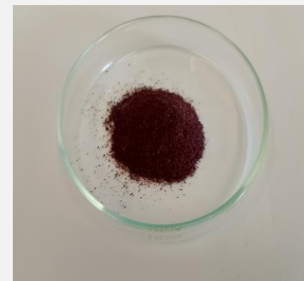
Rysunek 5 Proszek z pestek i skórek z winogron po rozdrobnieniu do wielkości cząstek 0,3 mm.
