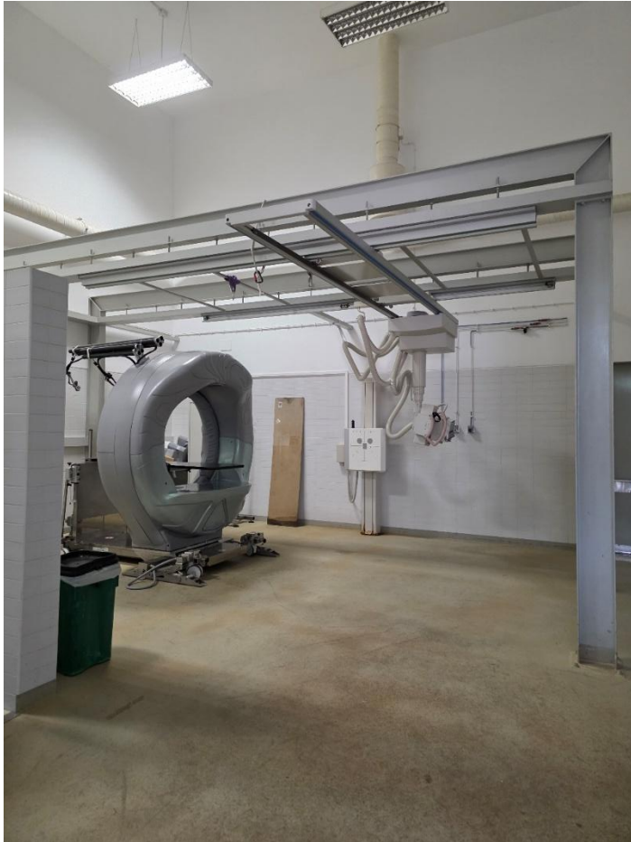
Aparat do tomografii komputerowej przeznaczony do badania koni.
