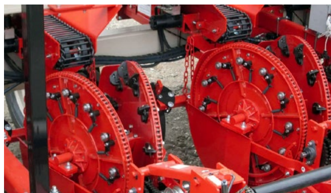
Zespoły tarcz wysadzających i przenośniki prętowe sadzarek chwytakowych firmy Harriston Industries. Źródło: https://www.harriston-mayo.com/harriston/equipment/pick-planter/#ip-carousel-143
