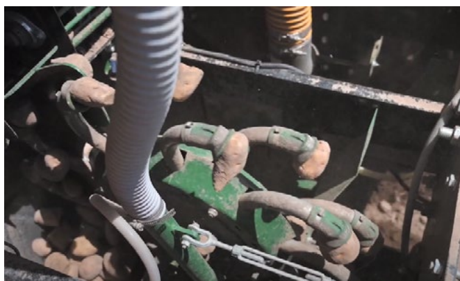
Podciśnieniowy zespół wysadzający sadzarek z serii 600 Air Cup firmy Lockwood Mfg. Źródło: https://www.youtube.com/watch?v=cFOe5KM_pDc
