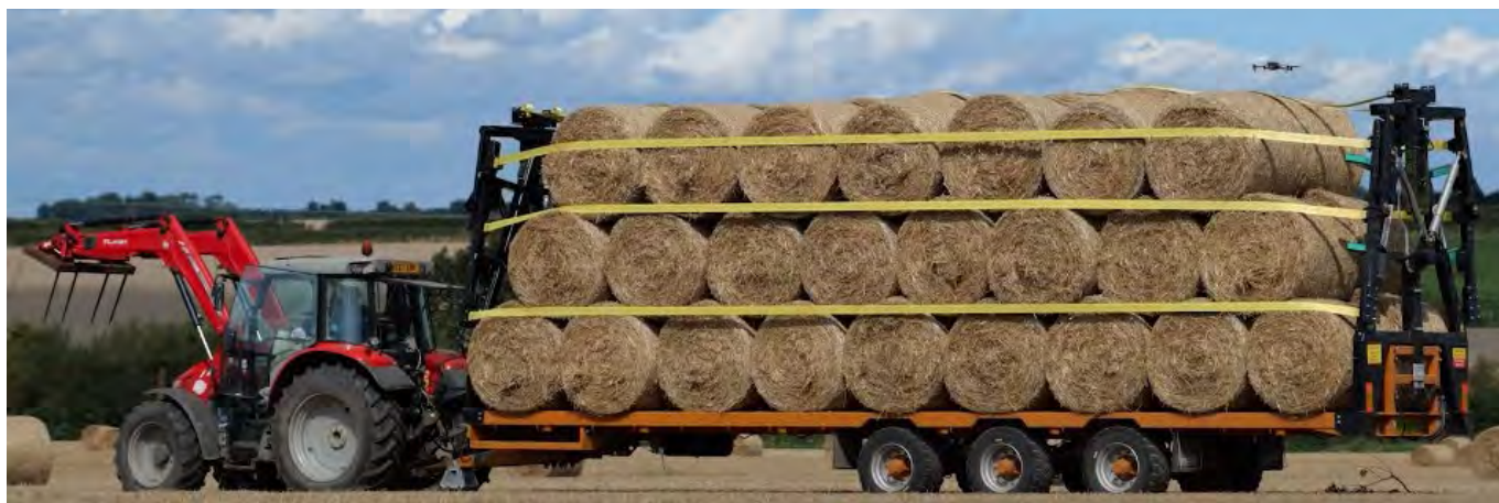
Transporter BTTA16/36 z system Safe Lock i górnym zaciskiem pasów zabezpieczających (źródło: https://www.youtube.com/watch?v=OwgX7snMgaE )
