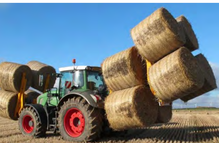
Dwuczęściowy, zawieszany na ciągniku transporter widłowy Octa-Quad podczas przemieszczania bel (źródło: https://www.murraymachinery.com/products/octa-quad-bale-handling-system )
