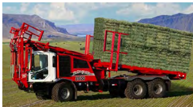
Samojezdny transporter dużych bel prostopadłościennych Stacker 8500 (źródło: https://www.stingerltd.com/cmsms/docs/218763_Stinger.pdf )
