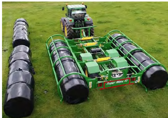
Samozaładowczy transporter bel cylindrycznych Super Move 10 (źródło: https://www.youtube.com/watch?v=Q-oYkcZWUGU )
