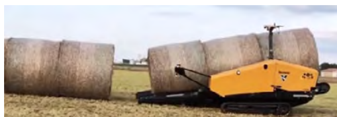
Autonomiczny transporter bel cylindrycznych Bale Hawk (źródło: https://www.youtube.com/watch?v=XlLOAerAPlw )
