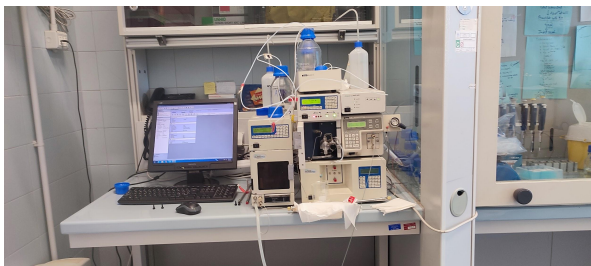
Wysokosprawny chromatograf cieczowy z detektorem światła UV
