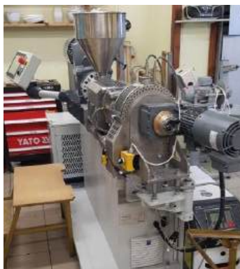
Rys. 1. Ekstruder jednoślimakowy EXP-45-32 (Zamak Mercator, Skawina, Polska).
