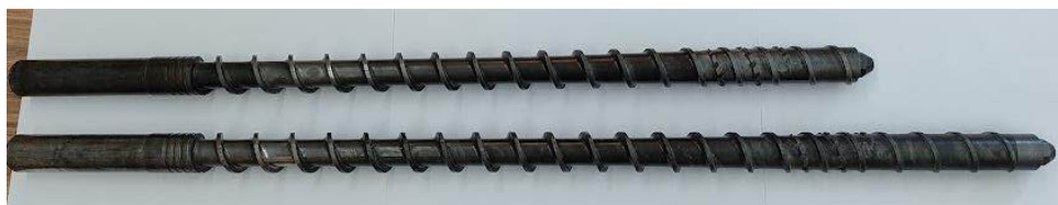
Rys. 2. Ślimaki ekstrudera dla układu plastyfikującego L/D=16 oraz 20.
