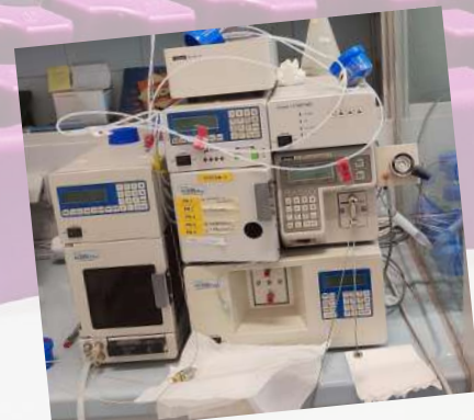
Po prawej wysokosprawny chromatograf cieczowy (HPLC) a po lewej wysokosprawny chromatograf cieczowy z detektorem światła UV (HPLC-UV)
