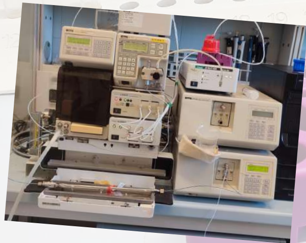
Po prawej wysokosprawny chromatograf cieczowy (HPLC) a po lewej wysokosprawny chromatograf cieczowy z detektorem światła UV (HPLC-UV)
