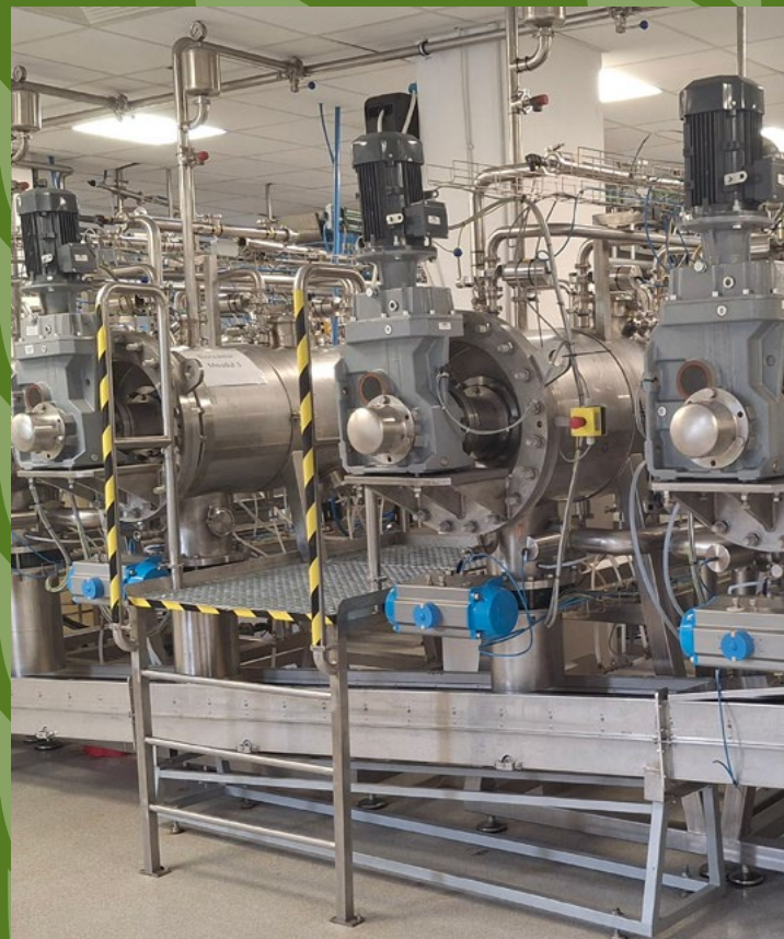
Reaktor do fermentacji śruty rzepakowej firmy InventionBio ( Bydgoszcz)
