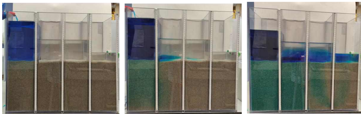
Rysunek 19. Przepływ wody z barwnikiem przez komory modelu filtra o przepływie meandrowym
