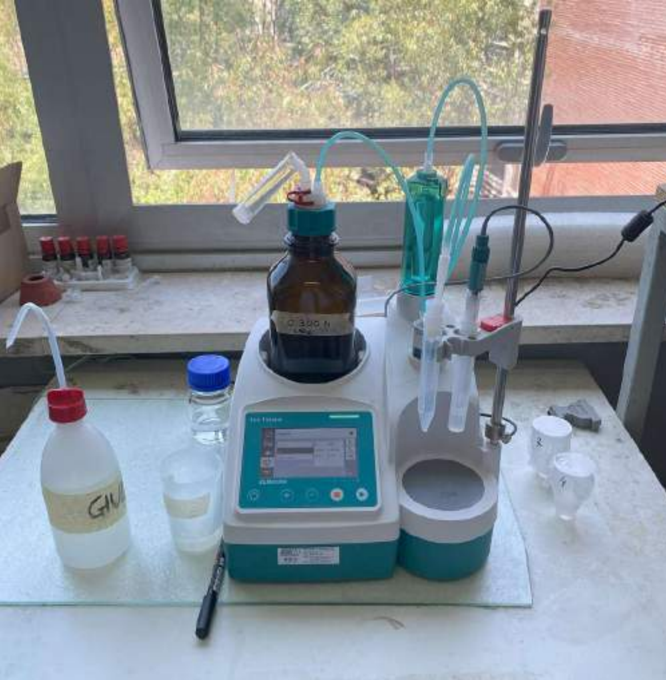
Automatyczny analizator do pomiaru zasadowości i lotnych kwasów tłuszczowych (VFA).
