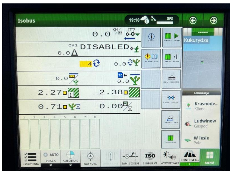
Ryc. 3. Ekran do obsługi siewnika punktowego w systemie ISOBUS oraz nawigacji (fot. P. Krasnodębski)
