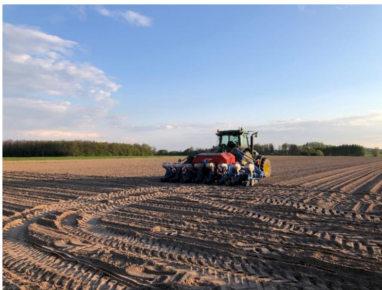
Ryc. 2. Ciągnik z siewnikiem do kukurydzy z systemem automatycznej kontroli sekcji (fot. P. Krasnodębski)
