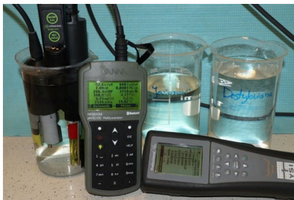
Ryc. 1. Pomiar parametrów wody przy wykorzystaniu trzech różnych mierników (fot. R. Kujawa)
