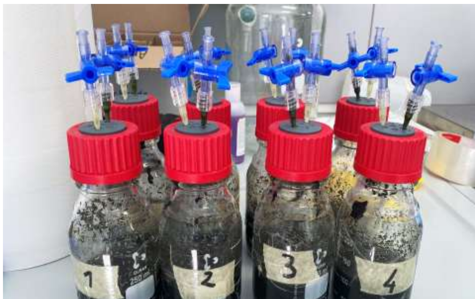
Fot. Test wsadowy do oceny właściwości fermentacyjnych badanych substratów.
