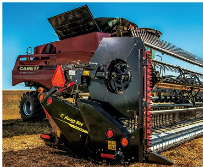
Heder AirFlex NXT wyposażony w dodatkowy przenośnik ślimakowy i aktywne rozdzielacze tań (Źródło: https://honeybee.ca/products/airflex-nxt/ )
