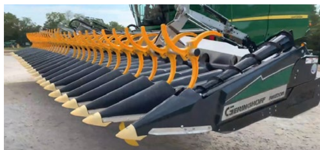
Heder 32-rzędowy z serii Freedom (Źródło: https://www.youtube.com/watch?v=i57AoQ5B5Dk )
