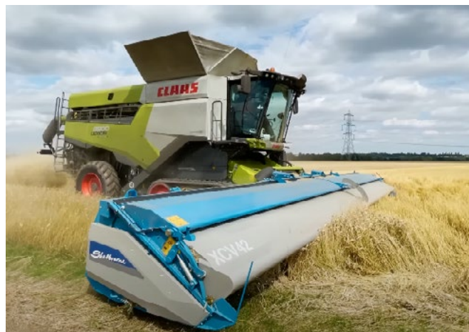
Zbiór wyległej pszenicy kombajnem Claas 8800 Lexion wyposażonym w heder XCS422 (Źródło: https://www.youtube.com/watch?v=tG3p1JyTZgE )
