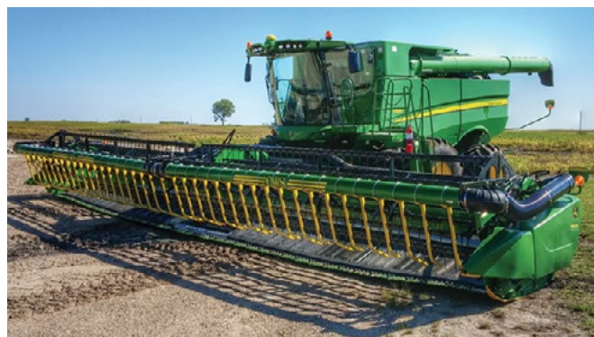
Kombajn John Deere z hederem wyposażonym w Crary Wind System (Źródło: http://crary.com/products/crary_wind_system/crary-wind-system )
