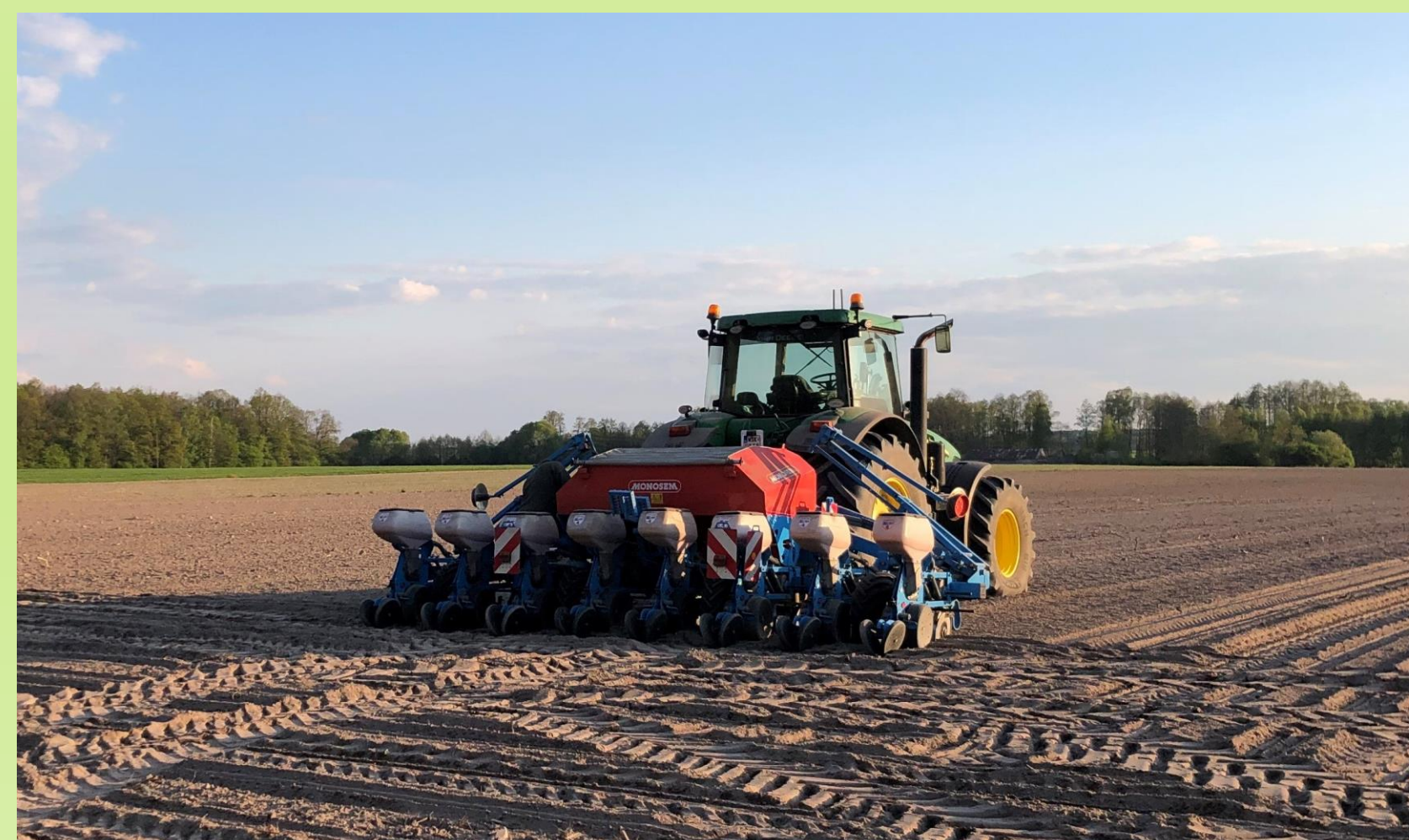
Rys.1. Ciągnik z siewnikiem do kukurydzy z systemem automatycznej kontroli sekcji
