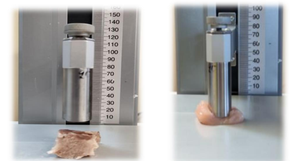
Fot. 2. Pomiar parametrów tekstury mięsa wieprzowego i drobiowego
