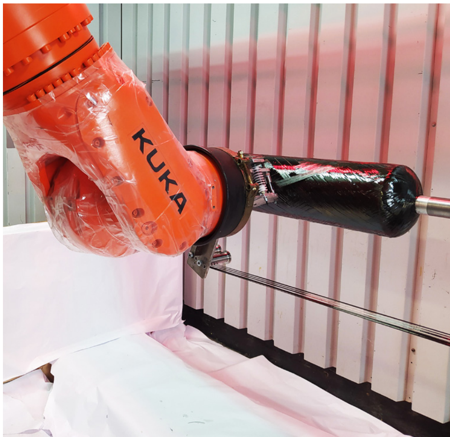
Fot. Robot KUKA podczas nawijania zbiornika
