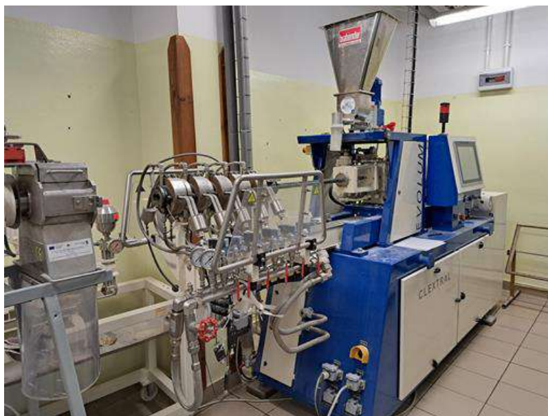
Rys. 4. Ekstruder dwuślimakowy EVOLUM25 firmy Cletral ( opracowanie własne ).
