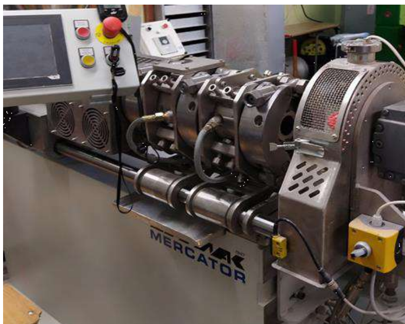
Rys. 3. Ekstruder jednoślindakowy z modułowym układem plastyfikującym (L/D = 16 lub L/D = 20) (opracowanie własne).
