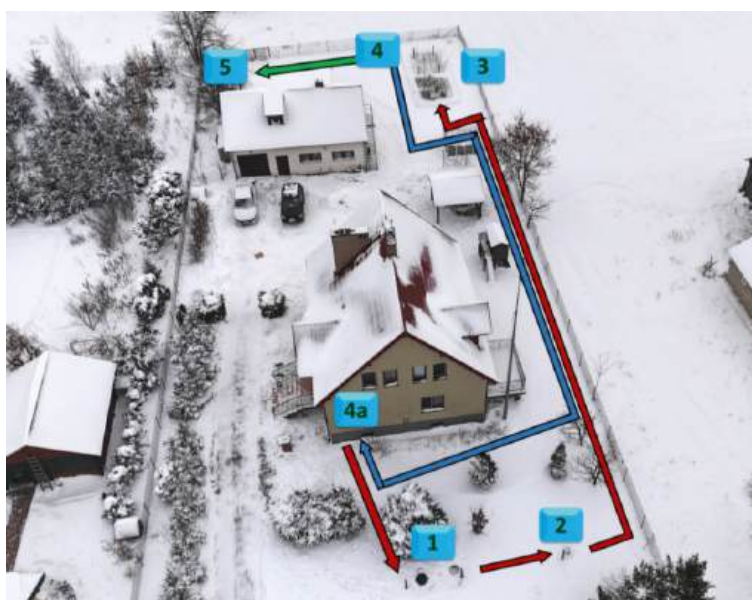
Rysunek 5. Lokalizacja głównych elementów hybrydowej hydrofitowej oczyszczalni ścieków z zamkniętym obiegiem wody na działce osady służbowej Poleskiego Parku Narodowego w Kulczynie (opracowanie własne).
