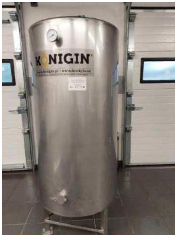
Fot. 6. Zbiornik z płaszczem grzejnym i zintegrowanym homogenizatorem o pojemności 300 litrów (fot. M. Czelej)
