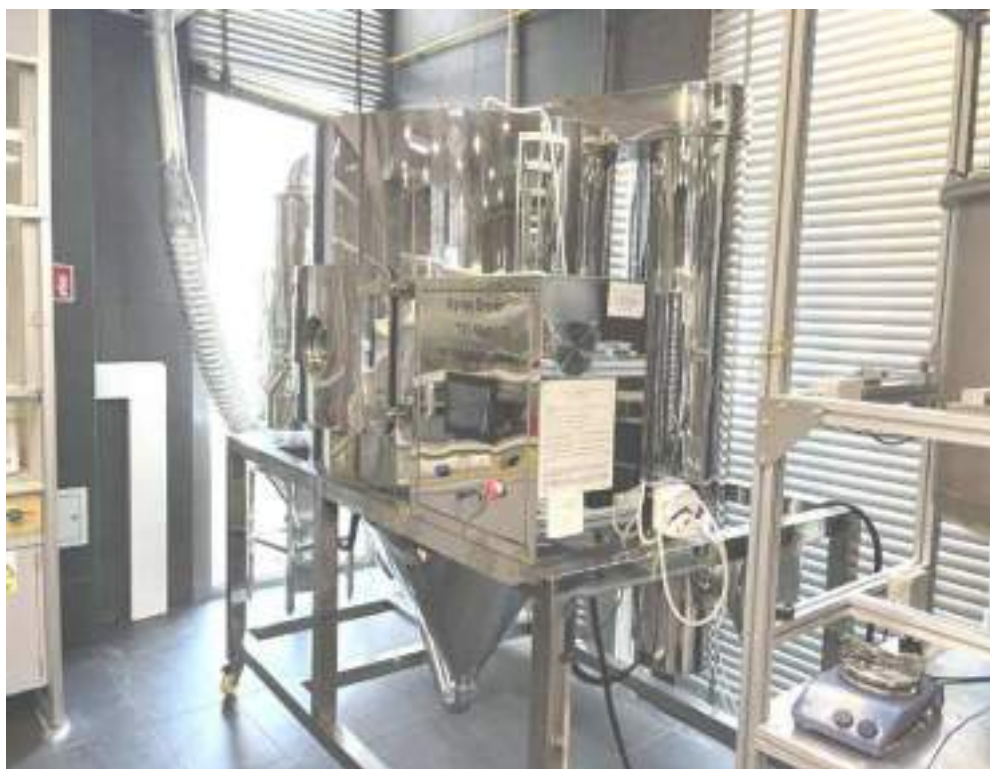
Fot. 4. Suszarka rozpyłowa Spray Dryer TP-S50 firmy Toption Group Limited (fot. M. Czelej)
