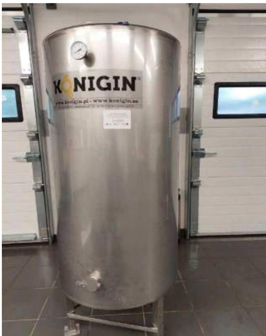
Fot. 1. Zbiornik z płaszczem grzejnym i zintegrowanym homogenizatorem o pojemności 300 litrów (fot. M. Czelej)
