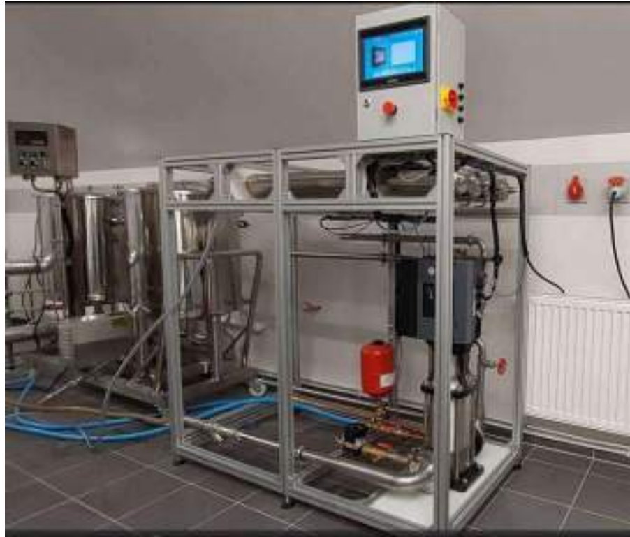
Fot. 8. Zestaw do ultrafiltracji uzbrojony w filtry z membraną o punkcie odcięcia 3 kDa (fot. M. Czelej)
