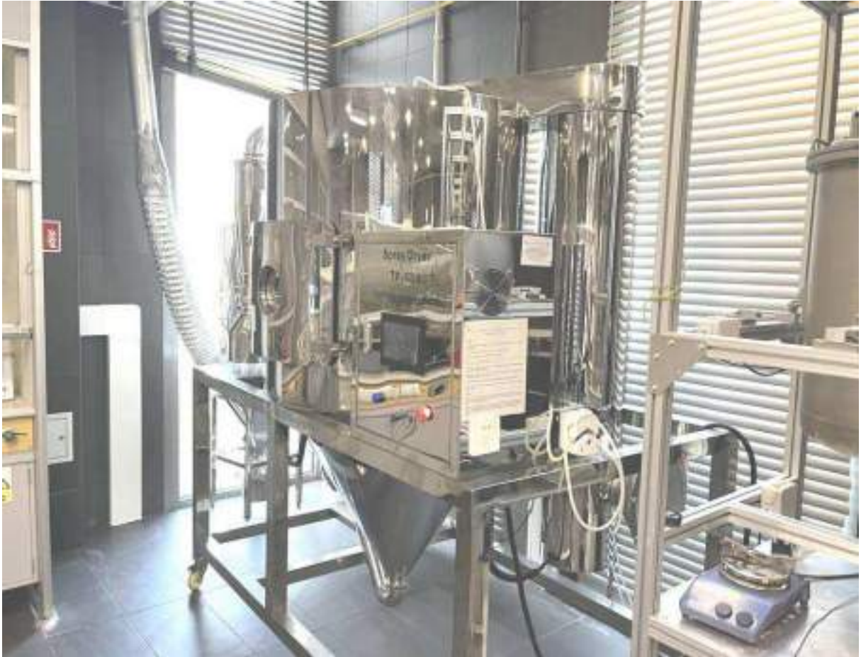
Fot. 10. Suszarka rozpyłowa Spray Dryer TP-S50 firmy Toption Group Limited (fot. M. Czelej)
