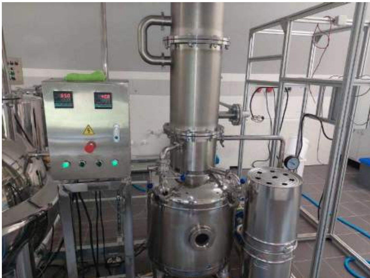
Fot. 3. Wyparka podciśnieniowa o pojemności 300 litrów z mieszadłem (fot. M. Czelej)
