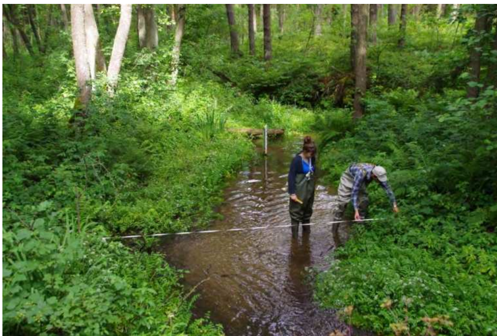
Ryc. 1. Pomiary przepływu prowadzone na rzece Świerszcz przez studentów kierunku geografia podczas studenckiego obozu naukowego, 10–14 lipca 2019 r. (fot. S. Wereski)
