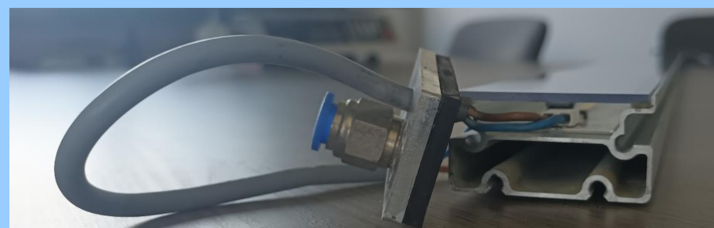
Fot. 1 Aluminiowy profil i uszczelka czołowa lampy
