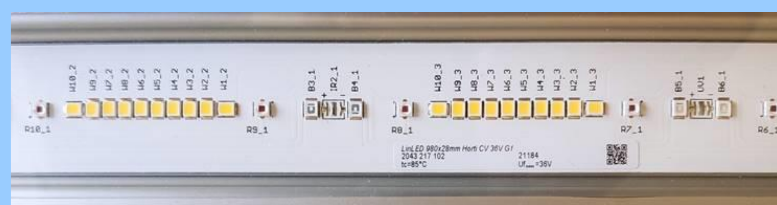
Fot. 2 Diody LED przyklejone do obudowy lampy
