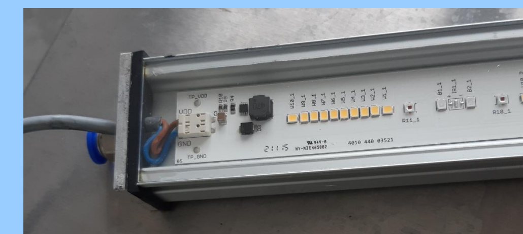
Fot. 3 Dwa obwody o napięciu 36 V i 24 V
