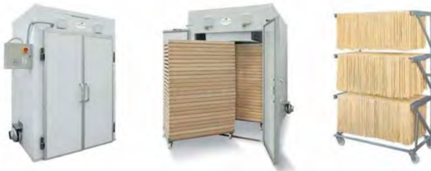
Ryc. 5. Suszarnie komorowe – widok ogólny oraz wózki do suszenia form krótkich i długich [na podstawie materiałów reklamowych firmy Pasfil, www.pasfil.com ; katalog maszyn on-line https://pubhtml5.com/sazy/thmr ; data dostępu: 5.03.2024]
