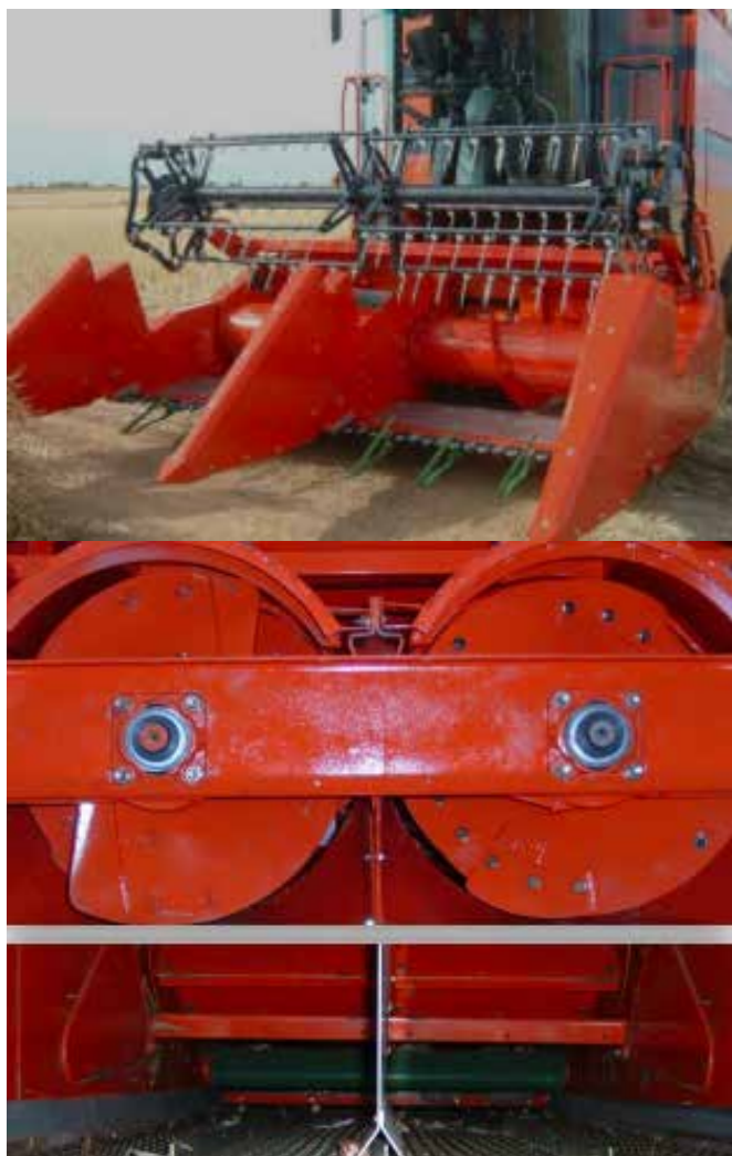
Kombajn DP4000 do plonów zbieranych niezależnie, jednocześnie z dwóch poletek: A – dzielony zespół zniwiny, B – tylna część dwóch bębnow młócająco-separujących i sit https://baural.fr/wp-content/uploads/2019/10/DP4000-EN-1.pdf
