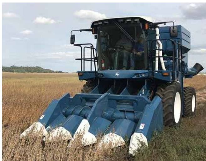
Kombajn poletkowy R2 firmy Almaco z dzielonym adapterem do zbioru soi https://www.almaco.com/store/c10/com-bines/p1458/r1-rotary-single-plot-combine/
