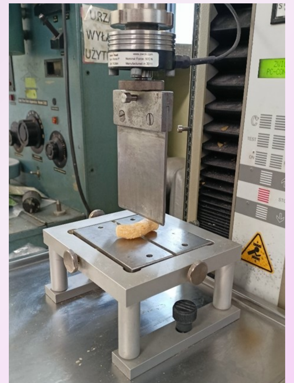
Teksturometr Zwick/Roell BDO-FB0.5TH (Zwick GmbH, Ulm, Niemcy) wyposażony w nóż Warner-Bratzlera
