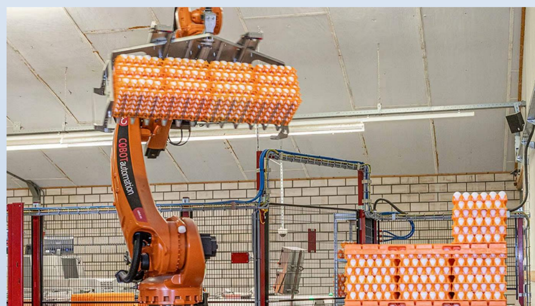
Robot KUKA do paletyzacji jaj kurzych umożliwia ułożenie do 108 000 jaj w ciągu godziny na paletach
