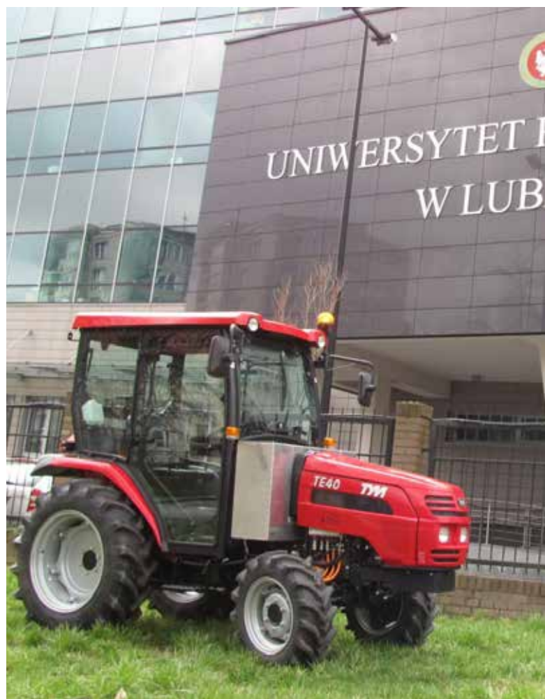
Prototyp ciągnika rolniczego wyposażonego w napęd elektryczny zrealizowany w ramach projektu w UP w Lublinie. Fot. Krzysztof Plizga
