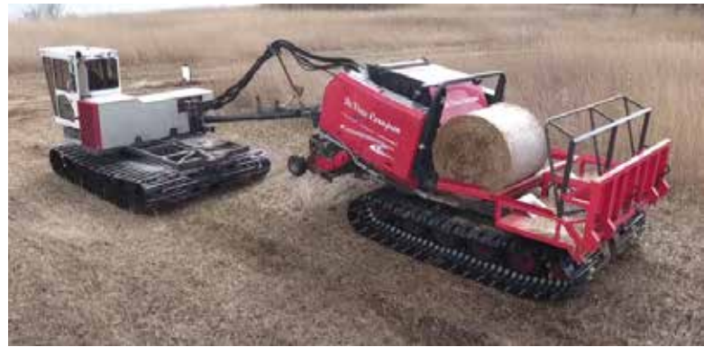
Zestaw firmy De Vries Cornjum B.V. do zbioru trzciny skoszonej maszyną SB Track Mower https://www.tiktok.com/@loiclagric/video/7299886090457058592
