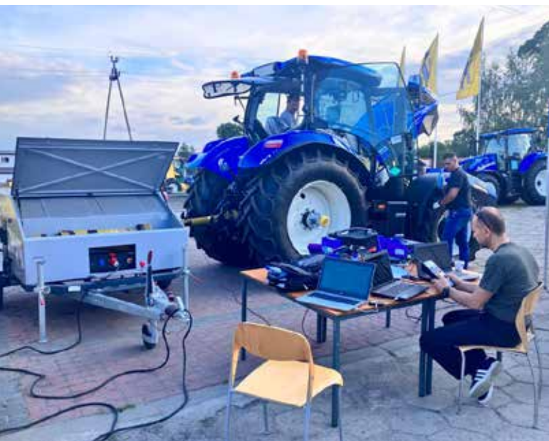
Badanie ciągnika zasilanego metanem, New Holland T6.180 Methane Power, które prowadzą pracownicy Katedry Energetyki i Środków Transportu UP w Lublinie. Fot. Agnieszka Dudziak
