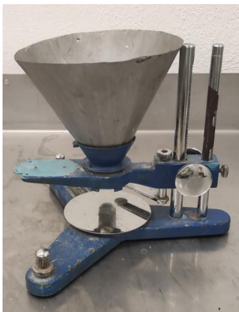
Fot. 8. Urządzenie do pomiaru kąta usypu
