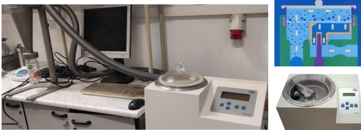
Fot. 5. Laboratoryjny separator pneumatyczno sitkowy RHEWUM LPS 200 MC
