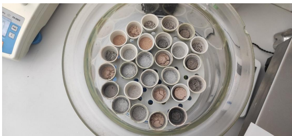
Fot. 20. Próbkę po spaleniu
