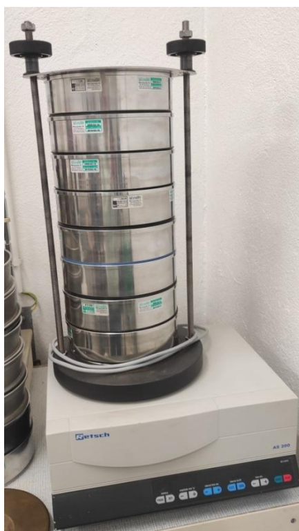
Fot. 6. Urządzenie do analizy sitowej typ Retsch AS 200
