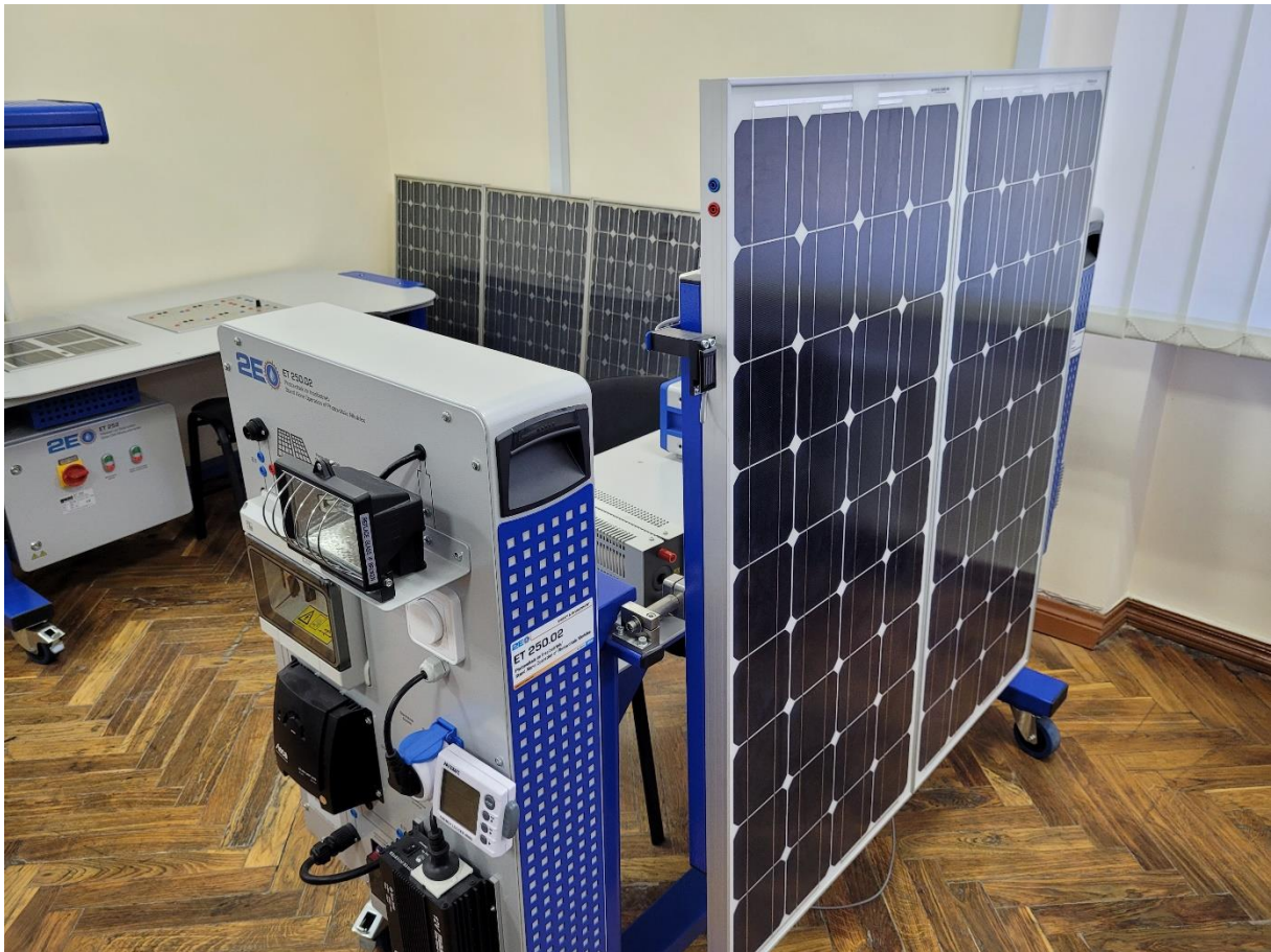
3. Zestaw do ćwiczeń - badanie układów fotowoltaicznych w różnych konfiguracjach.
