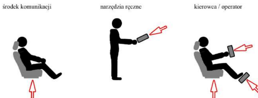
Ryc. 1. Schematy dróg przenikania drgań na człowieka
