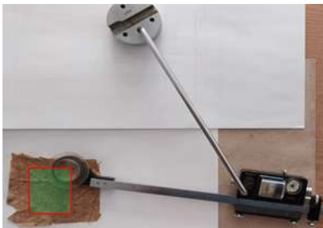
Ryc. 6. Planimetr biegunowy stosowany do wyznaczenia tzw. stałej planimetru na bazie kwadratu o polu 2500 \text{ mm}^2
