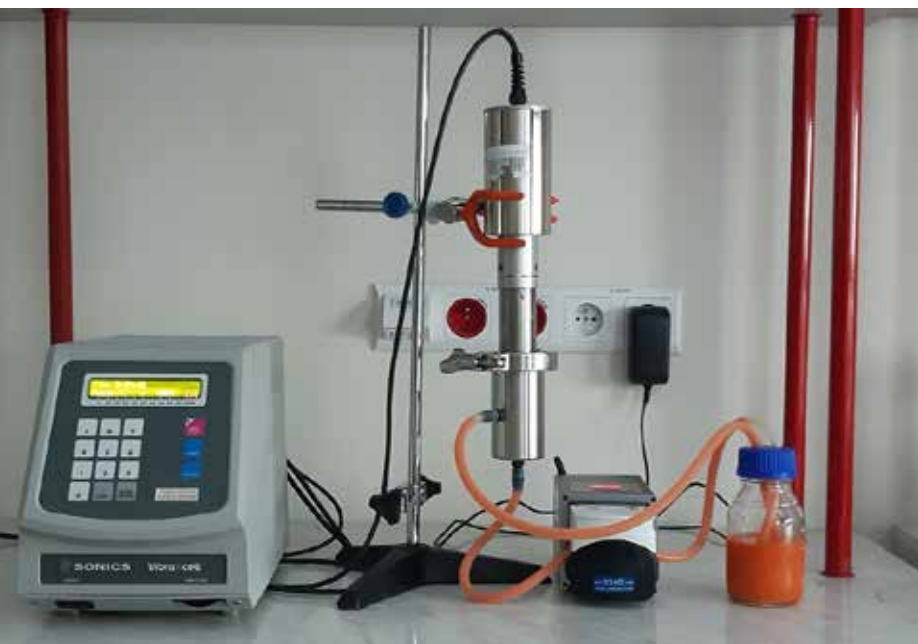
Układ doświadczalny do obróbki soku ultradźwiękami w systemie przepływowym Fot. Zbigniew Kobus
