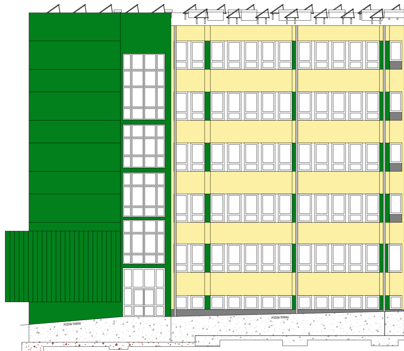
ELEWACJA C3 (WSCHODNIA SEGMENT C) SKALA 1:50
