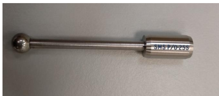
Rys. 3. Sonda użyta do badania jędrności i adhezyjności
