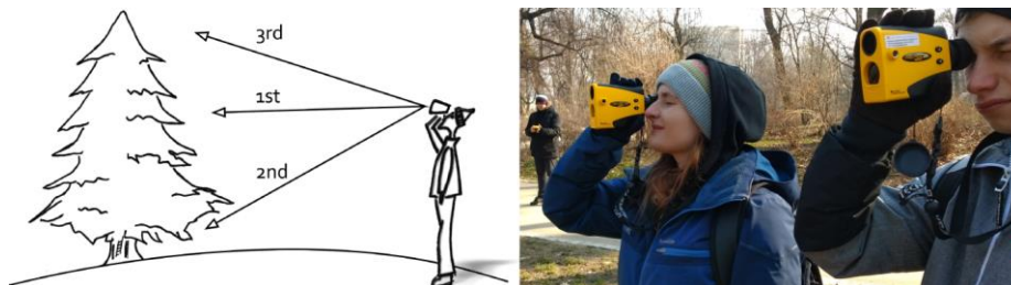
Rys. 1. Metoda pomiaru wysokości drzewa lunetowym dalmierzem laserowym wyposażonym w żyrokompas (a) testowana podczas studenckiej kampanii pomiarowej w lubelskim Ogrodzie Saskim (b); grafika. M. Zielińska, fot. S. Chmielewski
