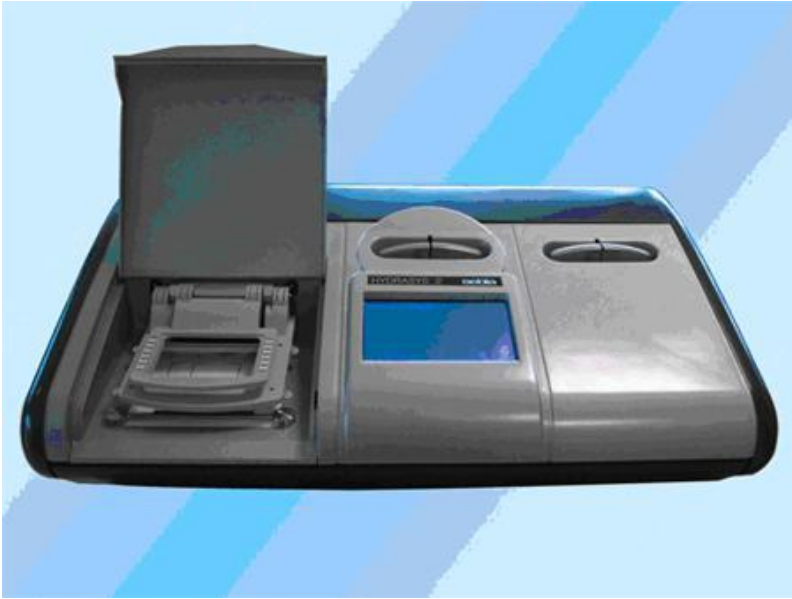
Rys. 9. Aparat do elektroforezy na żelu agarozowym do szybkiej elektroforezy dla potrzeb klinicznych
