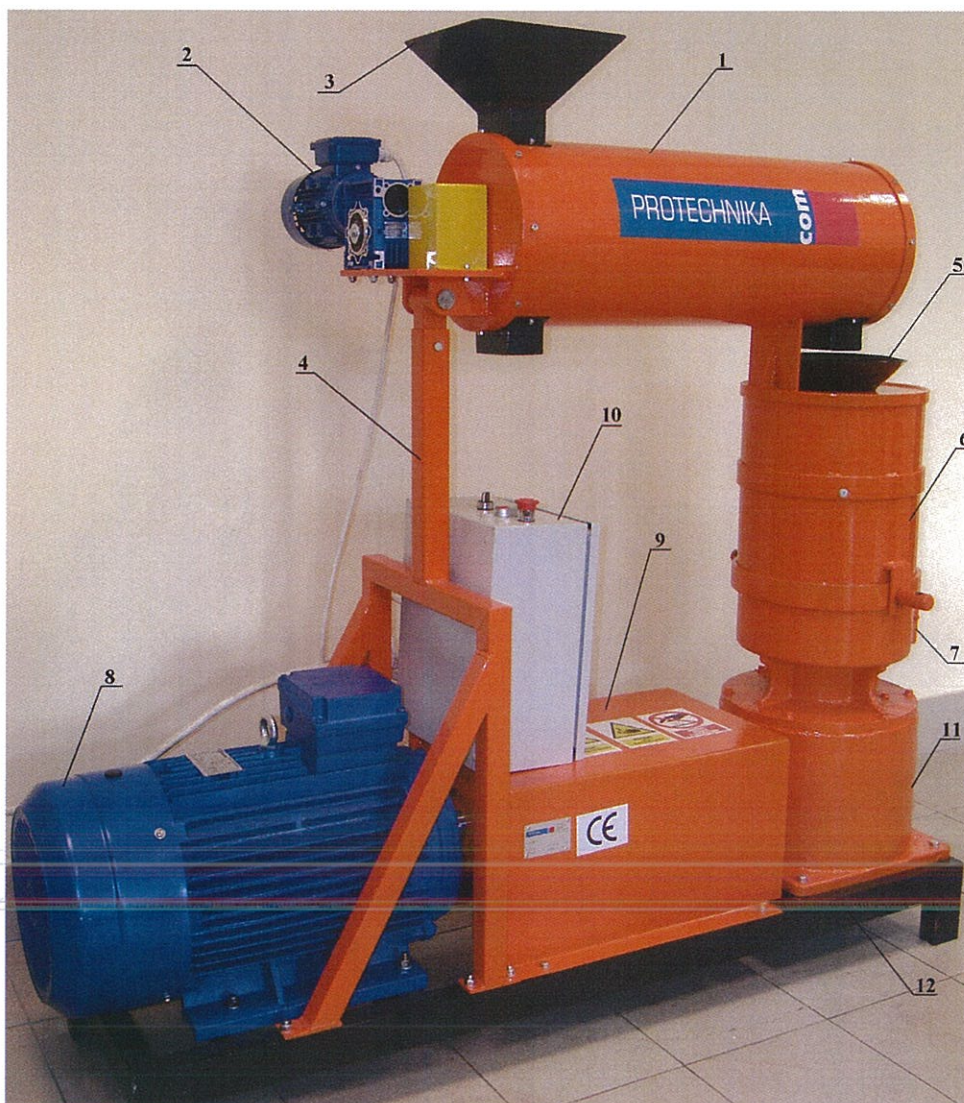
Rys. 1. Widok nowego urządzenia granulująco-brykietującego z płaską nieruchomą matrycą: 1-układ mieszająco-granulująco-dozujący, 2-napęd układ mieszająco-granulująco-dozującego, 3- zasyp surowca do układ mieszająco-granulująco-dozującego, 4- rama mocująca układ mieszająco-granulująco-dozującego, 5- wysyp surowca do układu roboczego granulatora, 6-układ roboczy granulatora, 7-wysyp granulatu z układu roboczego, 8-napęd granulatora (silnik elektryczny), 9-osłona sprzęgła i momentomierza, 10-panel sterujący, 11- przekładnia zębata, 12- podstawa
