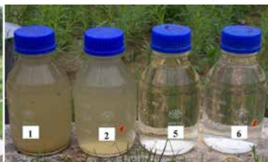
Hybrydowa hydrofitowa oczyszczalnia ścieków w Dąbrowicy oraz ścieki z poszczególnych etapów oczyszczania w układzie nr II (typu VF-HF) (1 – ścieki surowe, 2 – po osadniku wstępnym, 5 – po I złożu typu VF z trzciną pospolitą, 6 – po II złożu typu HF z wierzbą wiciową) Fot. Krzysztof Józwiakowski
