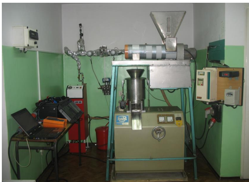
Rys. 1. Widok stanowiska badawczego procesu granulowania materiałów roślinnych (Katedra Eksploatacji Maszyn Przemysłu Spożywczego – Uniwersytet Przyrodniczy w Lublinie)
