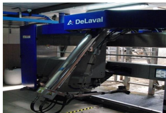
B - Widok robota udojowego w gospodarstwie
