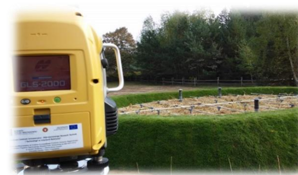
Naziemny skaniny hybrydowej hydrofitowej oczyszczalni ścieków na terenie Poleskiego Parku Narodowego
